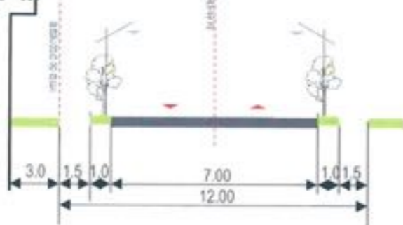
- profil transversal str. Automatizarii -
