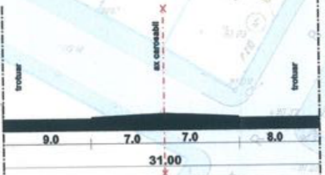
SECTIUNE PROFIL 1-1 SOSEAU A CHITILEI
